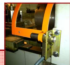
Soporte con eje de giro y micro eléctrico de seguridad.
